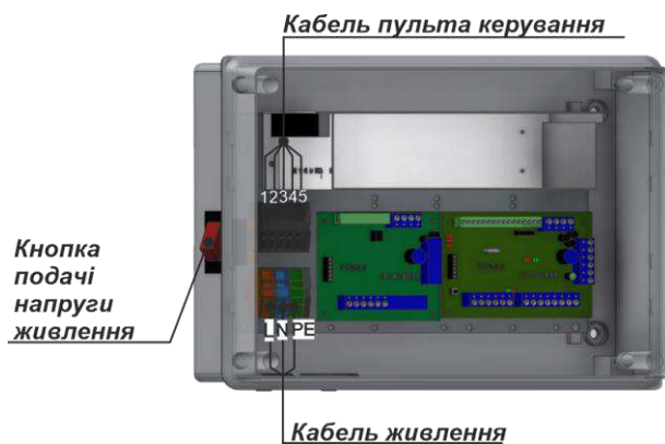
Рис.15– Блок електронного керування – підключення турнікету
