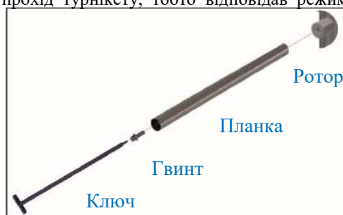
Рис.9– Складання основних елементів та встановлення планок турнікету
